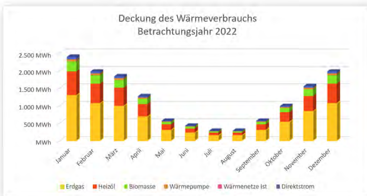
Abbildung 4.9: Lastgang des Wärmeverbrauchs im Jahr 2022, Dürnau
